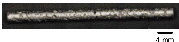
図 9 人工歯根用に切り出したポーラスチタン丸棒（直径 3.3 mm）．現在，ビーグル犬に埋め込み実験中である．
