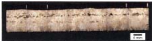
図 8 水素 1.0 MPa およびアルゴン 1.0 MPa の雰囲気下で二度加熱により作製したポーラスチタンの移動方向に平行な断面．二度目加熱の移動速度は 1000 \mu\text{ms}^{-1} ．
