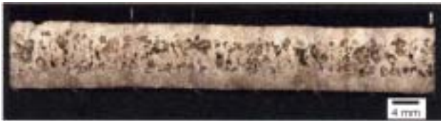
図 7 水素 1.0 MPa およびアルゴン 1.0 MPa の混合ガス雰囲気下で作製したポーラスチタンの移動方向に平行な断面．移動速度は 500 \mu\text{ms}^{-1} ．
