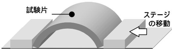
図9 従来型片振曲げ試験法
