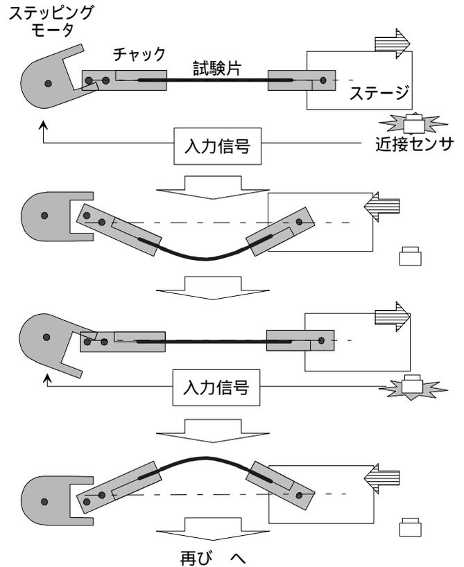
図11 両振り曲げ試験装置の動作概念図(真上からの観察図)
