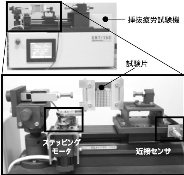
図10 両振曲げ疲労試験装置外観
