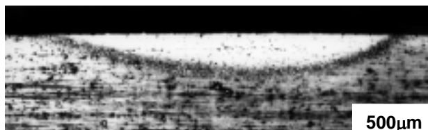
図1 レーザー表面溶体化層の断面光学顕微鏡写真（デフォーカス距離：20mm，ビーム移動速度：16.7mm/s）
