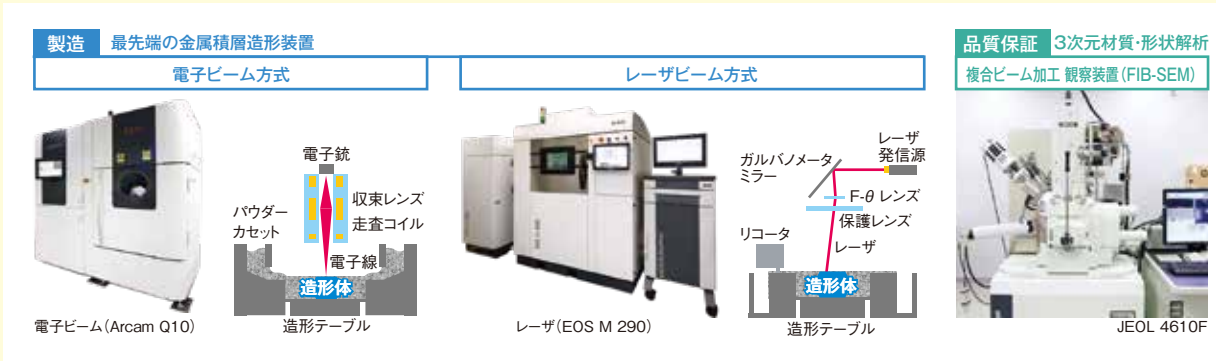
図1 大阪大学・異方性カスタム設計・AM研究開発センターが保有する主な装置 資料提供: 大阪大学大学院工学研究科中野貴由教授
