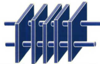
開発に成功した「格子ラメラ組織」（上）とその模式図（下）。このような格子状の組織をつくったことで高温耐性と強さを両立させた。
