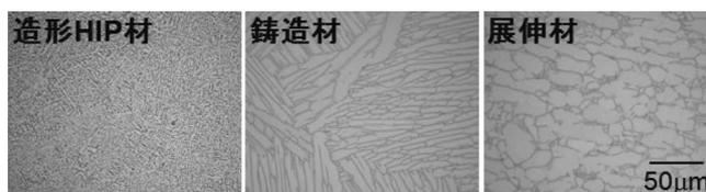
図9 EBM造形材 (HIP処理後)、鑄造材、展伸材の微細組織
