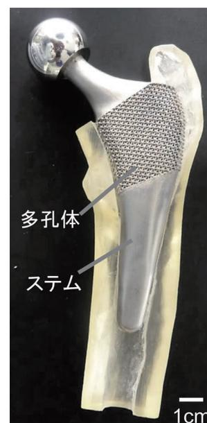
図6 EBM法により作製した患者骨格に適合したTi-6Al-4V合金製カスタム人工股関節インプラント
