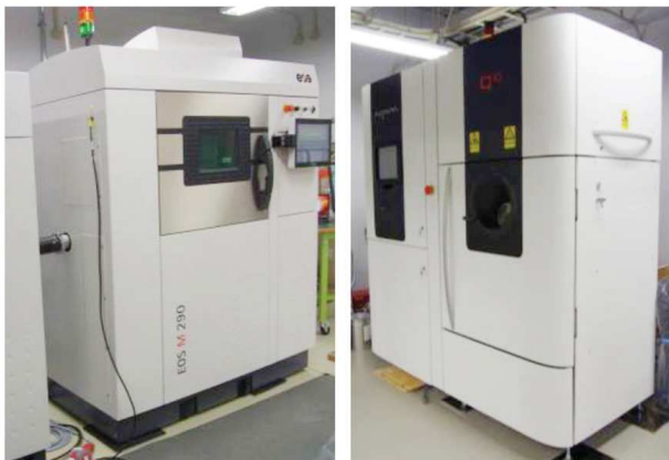
図4 難加工材の積層造形装置 （左）レーザービーム積層造形装置 （右）電子ビーム積層造形装置
