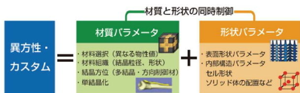
図1 材質・形状パラメータ同時制御による異方性・カスタムの実現
