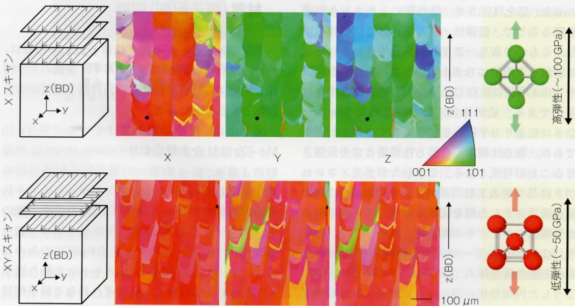
図 7 レーザビーム金属 3D プリンタによる  $\beta$ 型 Ti 合金の原子配列制御
