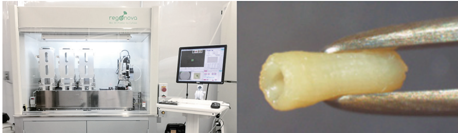
図表5 三次元細胞積層システム「レジェノバ」
