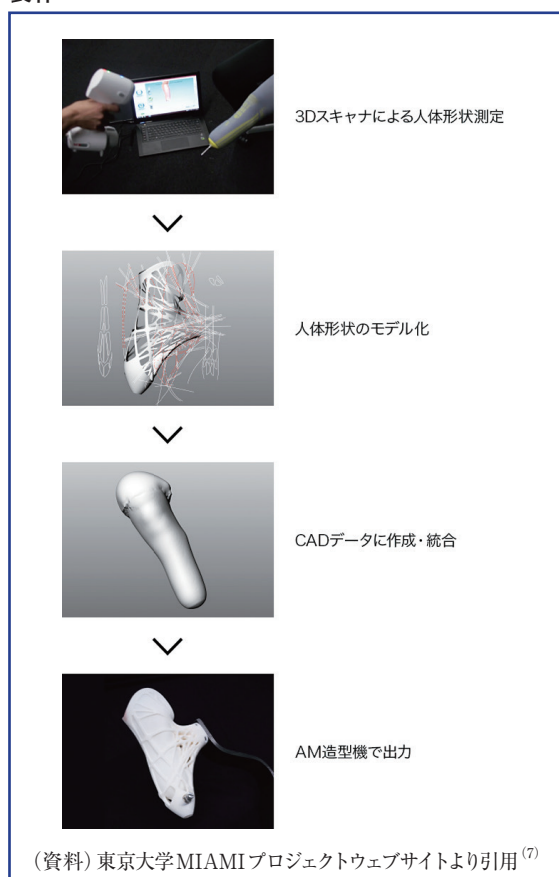
図表1 3Dプリンタ技術を用いた陸上競技用義肢の製作
