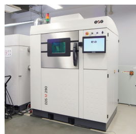
①レーザビーム積層造形装置
