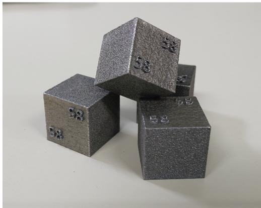
図1 SUS420J2のレーザ積層造形体試験片(サイズ: 11 mm×11 mm×11 mm). (オンラインカラー)
