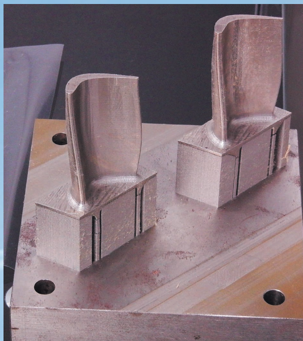
図4 AMによる単結晶タービン翼
