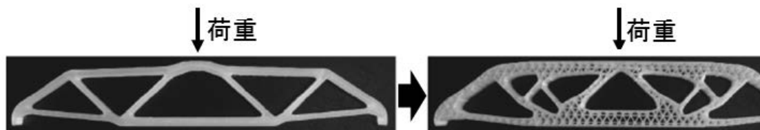
図4 トポロジー最適化法による形状パラメータの最適化
