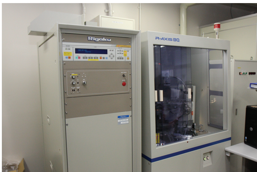
図 1. 骨質評価X線回折装置「R-AXIS BQ」
