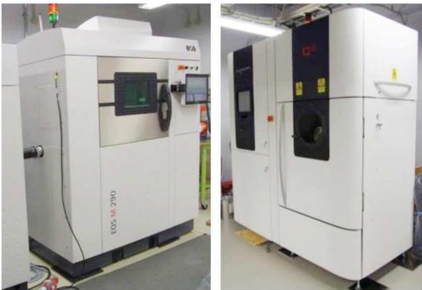
図4 難加工材の積層造形装置
