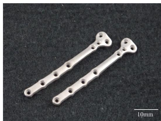
図2 三次元積層造形による実体化。
